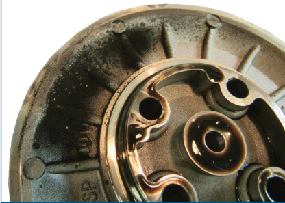
FOTO 1 ACCUMULO DI FULIGGINE SUL PIATTO OLIO.
