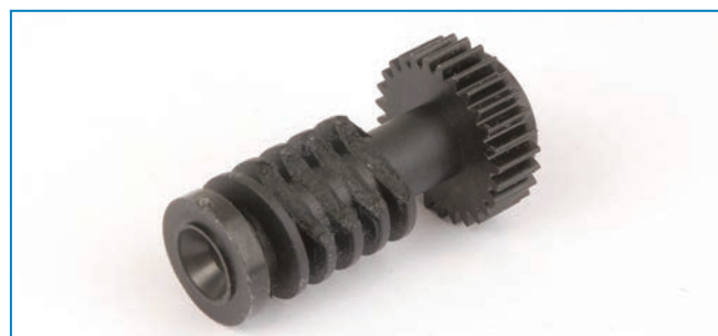
Guasto all'ingranaggio a vite senza fine a causa del funzionamento limitato del meccanismo VNT.
