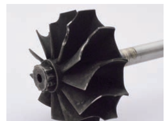
Guasto alla girante turbina dovuto a HCF
