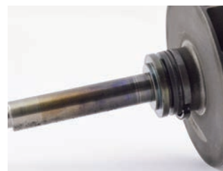
Passaggio di calore dal lato turbina
