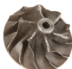
Danni all'induttore della Girante Turbina
