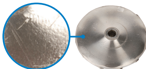
Effetto superficie a "buccia d'arancia" sulla Girante Compressore
