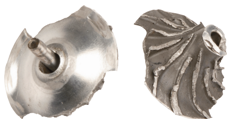
Guasto totale del componente
