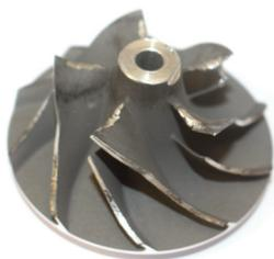
Sfaldamento delle palette del compressore
